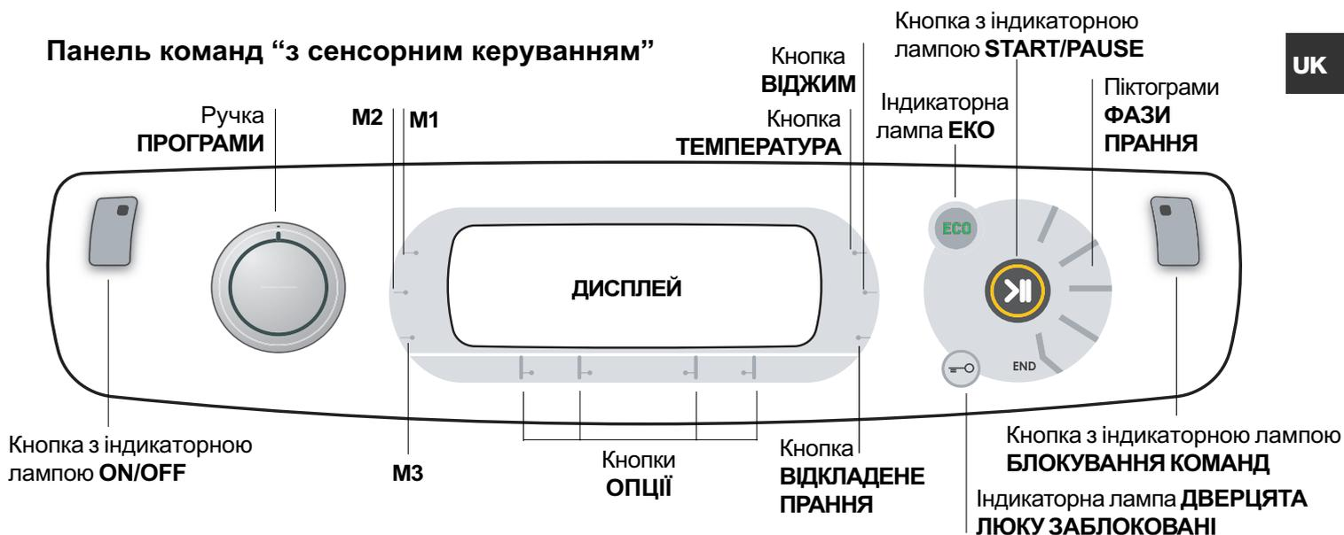
Кнопка з індикаторною лампою **ON/OFF**: швидко натисніть і відпустіть кнопку для вмикання або вимикання машини. Зелена індикаторна лампа означає, що машина ввімкнена. Для вимикання пральної машини під час прання необхідно утримувати кнопку натиснутою приблизно більш ніж 3 сек.; короткочасне або випадкове натискання не дозволить вимкнути машину. Вимикання машини під час циклу прання відмінює це прання.
