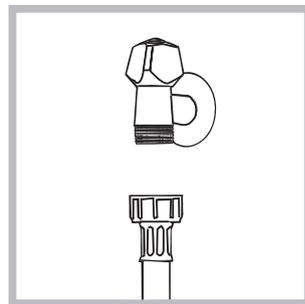
2. Підключіть трубу для подачі води, прикрутивши її до крану холодної води з різьбою  $\frac{3}{4}$  (див. малюнок)
