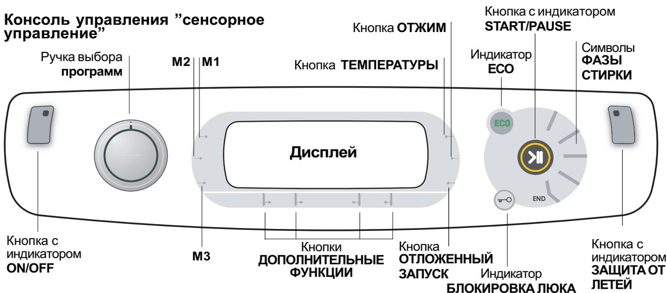
Кнопка с индикатором **ON/OFF**: нажмите кнопку один раз для включения или выключения машины. Зеленый индикатор показывает, что машина включена. Для выключения стиральной машины в процессе стирки необходимо держать нажатой кнопку, примерно 3 секунды. Короткое или случайное нажатие не приведет к отключению машины. В случае выключения машины в процессе стирки текущий цикл отменяется.
